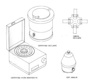
La centrifugación es una técnica de transporte basada en el movimiento de las partículas, suspendidas en un medio líquido específico, impulsadas por una fuerza denominada centrífuga, que tiende a desplazarlas hacia fuera del centro de rotación. Tanto la viscosidad de la disolución-muestra (esto es de gran interés para las aplicaciones analíticas) como las propiedades físicas de las partículas afectarán a la sedimentación individual de las mismas.
